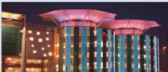
L'edificio di Auchan, a Cinisello Balsamo, utilizza 18 barre ledline 2 Rgb di Philips regolate con il sistema di controllo Color Chaser Dmx
